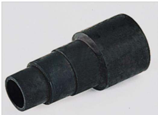
Adaptateur universel, pour raccorder les machines avec un embout d'aspiration Ø 25-32 mm à un flexible d'aspiration Ø 32 mm ou avec l'extension du tuyau d'aspiration (296.953). Adaptateur conçu pour trois diamètres différents.
